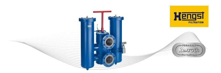
Doppelfilter werden in Hydraulikanlagen zur Abscheidung von Feststoffen aus Fluiden und Schmierölen eingesetzt. Sie sind zum Einbau in Rohrleitungen vorgesehen und erlauben den Wechsel des Filterelementes ohne BetriebsUnterbrechung.
