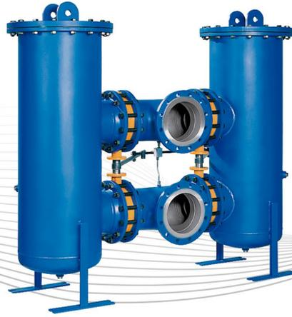
Doppelfilter werden in Hydraulikanlagen zur Abscheidung von Feststoffen aus Fluiden und Schmierölen eingesetzt. Sie sind zum Einbau in Rohrleitungen vorgesehen und erlauben den Wechsel des Filterelementes ohne Betriebsunterbrechung.
